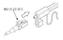
3. 推动外壳开始清洁 MU/LC 连接器端面。 "咔嗒" 声表示清洁过程结束。 使用后盖上防尘盖。
